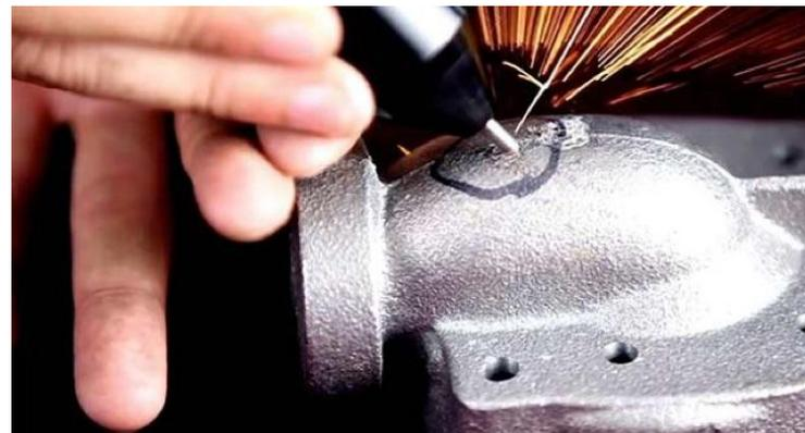
**Электроискровая микросварка вращающимся электродом** – это еще один вид современного ремонтно-восстановительного сварочного оборудования. Перенос материала электрода происходит в импульсном режиме искровым разрядом. Для получения сплошности наносимого слоя, а так же равномерного сгорания электрода, электрод в процессе работы вращается вокруг своей оси. Одновременно с этим через сопло вокруг электрода подается инертный газ.
